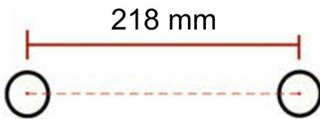
1.- Se realizan 2 barrenos  $\varnothing 1/4$ , con una distancia central de 218 mm.
