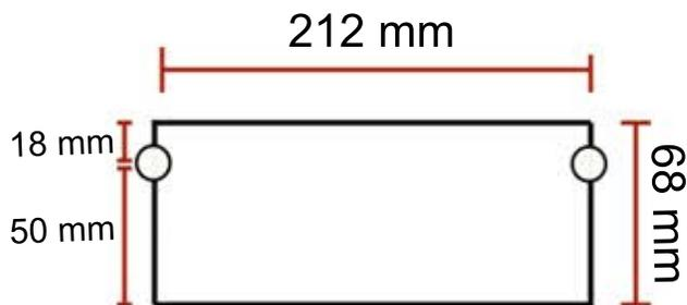
2.- Se realiza el corte rectangular partiendo del centro del barreno siguiendo las medidas presentadas en la figura.
