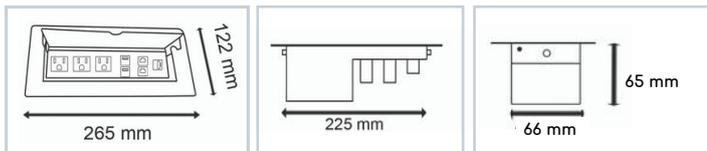
\*Su montaje requiere de un orificio de 225 x 68 mm
